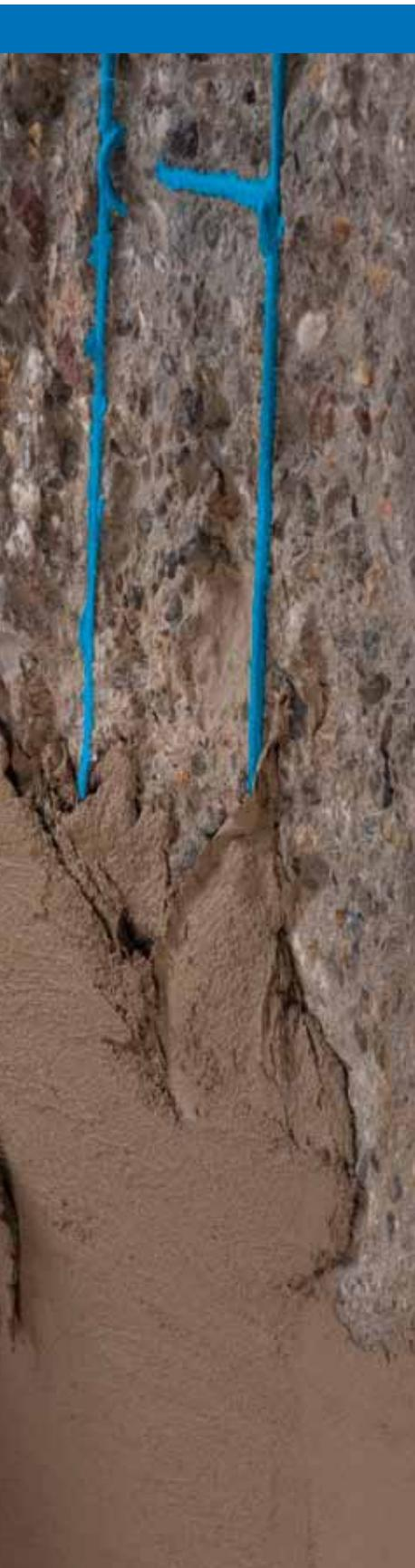
**Mapegrout Colabile:** Mortero de retracción compensada, fibrorreforzado, para el saneamiento del hormigón; Clase R4 según UNE EN 1504-3.
