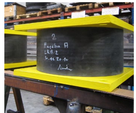
1 Ensayo sobre apoyos LASTO®LRB 2 Producción de apoyos LASTO®LRB
